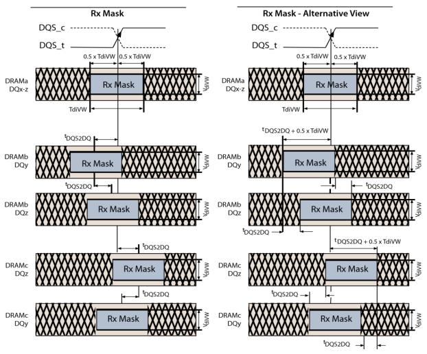
Figure 68 - Rx Mask DQ-to-DQS Timings
