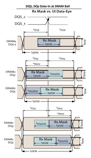
Figure 69 - Rx Mask DQ-to-DQS MRAM-Based Timings
