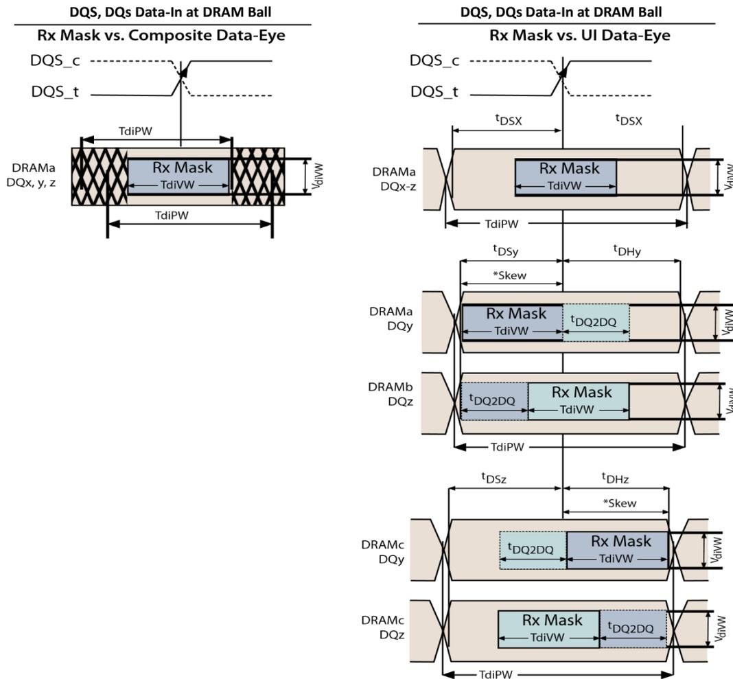
**Figure 69 - Rx Mask DQ-to-DQS MRAM-Based Timings**
