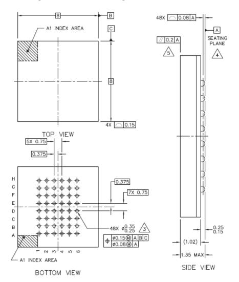
TOP VIEW A1 CORNER 123456 BOTTOM VIEW A1 CORNER В 8.00±0.10 С ¢0.05 ₩ C Ø0.25 M C A B Ε ø0.30±0.05(48X) 000 ⊕00 0 0 0 0 0 0 8.00±0.10 Α <u>0 0 0 0 0 0 0</u> В 6.00±0.10 000 0.55 MAX. 000 000 // 0.25 C 0.21±0.05 000000 ⊕ O O O Α 1.00 MAX 0.26 В 6.00±0.10 □ 0.15(4X)
